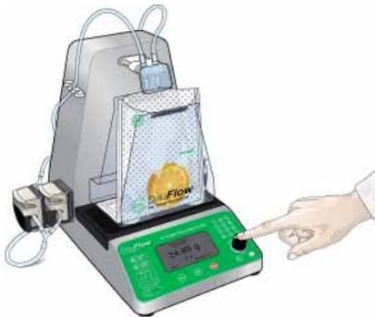
Ajouter le diluant avec le dilueur gravimétrique **DiluFlow®**.
