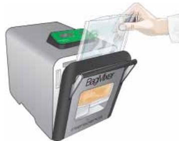
L'échantillon est homogénéisé avec son diluant dans le malaxeur à pales **BagMixer®**. La filtration de l'échantillon se fait dans le sac-filtre pendant le malaxage.
