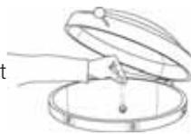
Mettre 1 gélule dans le fond d'eau de l'autoclave ou dans un récipient avec de l'eau.
