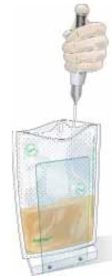
Pipeter l'échantillon avec **BagPipet®**. La filtration est stérile et immédiate. L'échantillon est prêt à être analysé.
