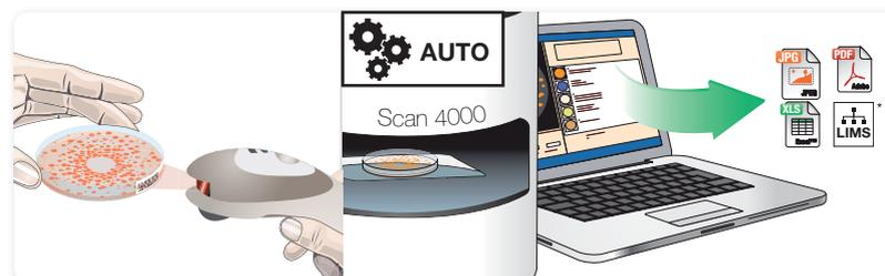
Une fois les colonies développées, scanner le code Datamatrix. Le compteur de colonies Scan® se règle automatiquement grâce aux données de l'étiquette Datamatrix. Cliquer sur « Compter ». Exporter les données.
