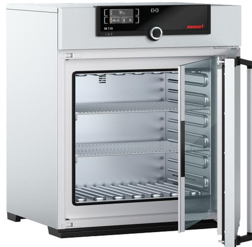
Le chauffage de cet incubateur est adapté aussi bien à la convection naturelle qu'au brassage d'air forcé, c'est pourquoi il est possible d'éteindre complètement le ventilateur et de réchauffer de manière particulièrement douce les éléments de chargement précieux dans le cadre de travaux dans le domaine de la recherche, de la pharmacie, de la médecine et de la chimie alimentaire.
