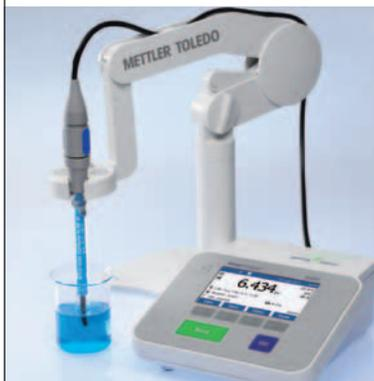
uPlace™ : actionnable d'une main, le bras de l'électrode vous permet de la déplacer vers le haut/bas et de la positionner au meilleur endroit pour votre échantillon. Ainsi, vous gagnez du temps sur les mesures et réduisez le risque de renverser le récipient et/ou d'endommager le capteur.
